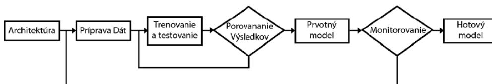
Obr. 1 Kroky návrhu algoritmu pre rozpoznávanie obrazu.
