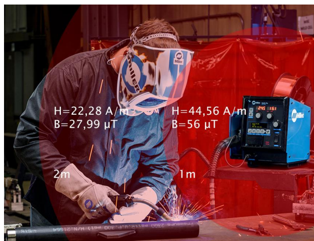
Obr. 5 Rozloženie intenzity magnetického poľa a magnetickej indukcie v okolí zväracieho zariadenia
