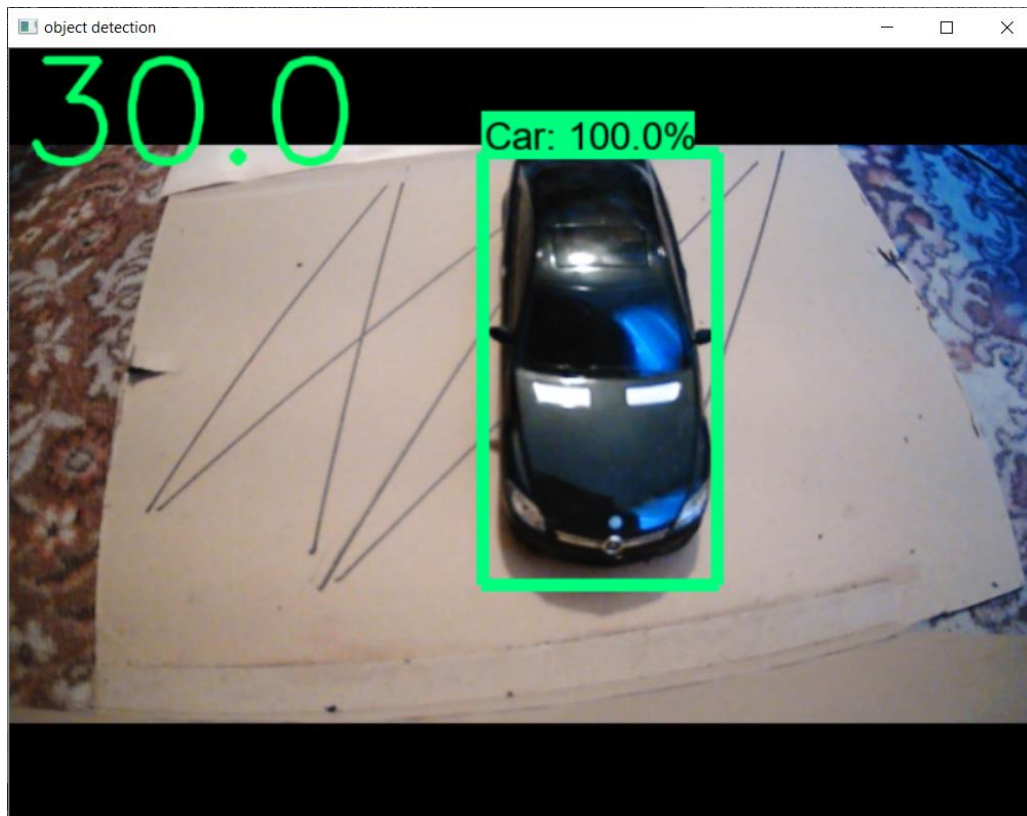
Obr. 3 Vyhodnotenie FPS a presnosť klasifikácie auta označeného v zelenom obdĺžniku.
