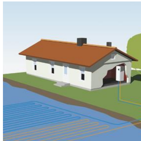
Obr. 10 Tepelné čerpadlo typu zem – voda (studňa) [5]
