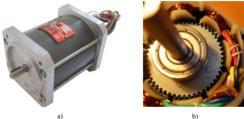
Obr. 1 Krokový motor MEZ Z420L177 a) a detail vnútra krokového motora [1] b)
