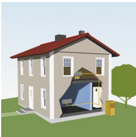
Obr. 4 Tepelné čerpadlo typu vzduch – vzduch [5]
