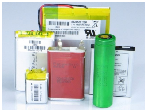
Obr. 2 Rozdielne tvary li-ion batérií
