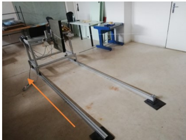
Obr. 3 Meracia sústava pre estimáciu hrúbky steny so smerom posunu
