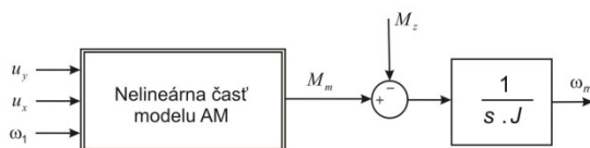
Obr. 5 Štruktúra systému s asynchrónnym motorom
