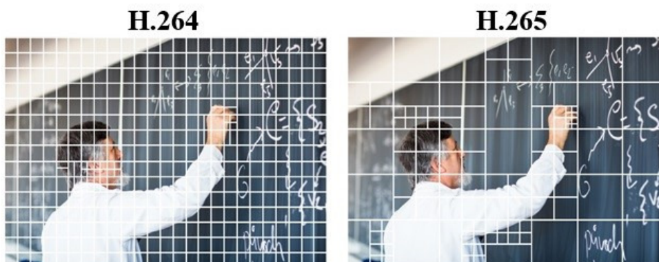
Obr. 3 Rozdelenie na bloky H.264 a H.265 [3]
