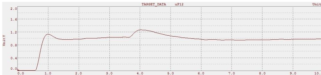
Obr. 7 Grafický priebeh ťahu v páse F_{12} odsnímaný počas HIL simulácie
