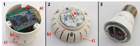
Obr.3. Integrácia Arduino dosky do existujúcej žiarovky.
