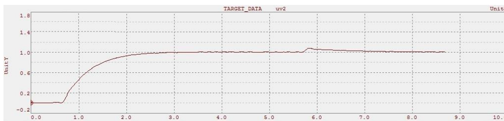
Obr. 8 Grafický priebeh obvodovej rýchlosti v_2 odsnímaný počas HIL simulácie
