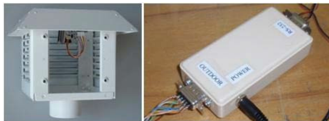
Obr. 1 Hardvérová konfigurácia senzora umožňujúceho monitorovať výskyt hmly
