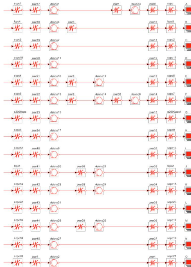
Obr.4 Schéma simulovanej siete PON v programe OptSim.
