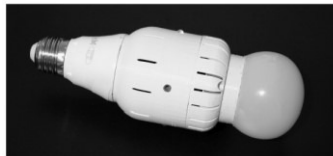
Obr.4. Upravená LED žiarovka pre použitie v LiFi technológii.
