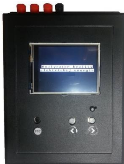
Obr. 1 Analyzátor kvality elektriny – pohľad spredu
