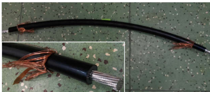
Obr. 2 Použitá vzorka kábla (NA2XS2Y) pre meranie
