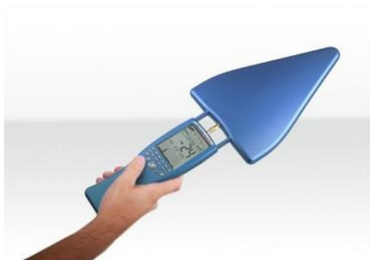
Obr. 1 Pohľad na merací prístroj HF60105 s vysokofrekvenčnou anténou
