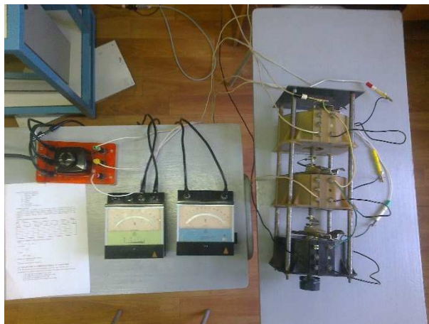
Obr. 3 Detail zapojenia pre skúšku synchronného generátora sklzovou metódou
