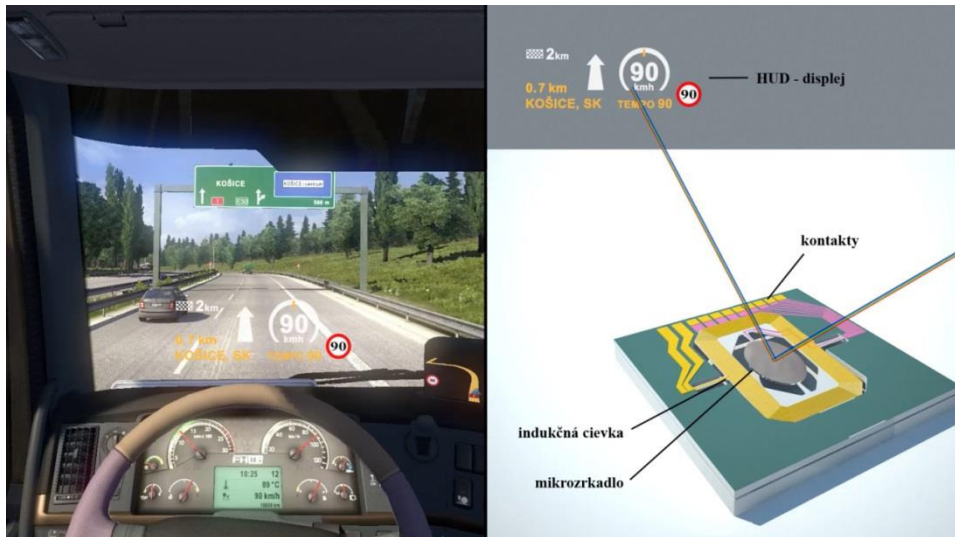
Obr. 5 HUD displej využívajúci MEMS skener, zobrazujúci navigáciu, informácie o rýchlosti a dopravnom značení na sklo
