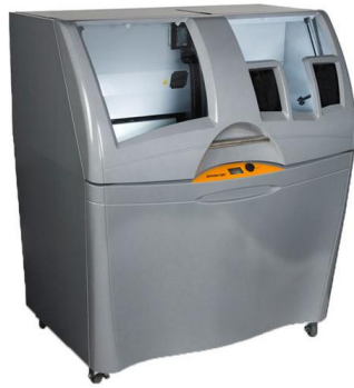
Fig.2. Prášková tlačiareň v laboratóriu LIRKIS - ZPrint 450[1]
