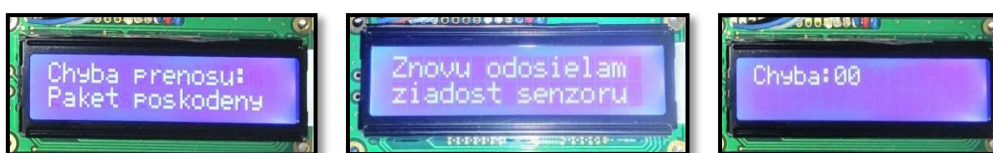
Obr. 9 Chybová správa po kontrole CRC súčtu (vľavo), opakovanie žiadosti po chybe prenosu (v strede), kód protokolovej chyby vrátenej senzorom [10].
