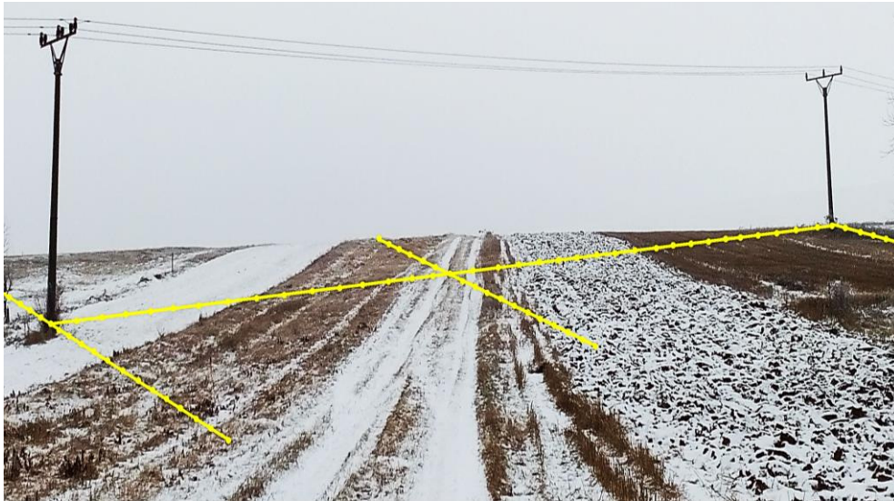
Obr. 1 Zobrazenie bodov merania na rozpätí betónových stožiarov pre výšku 0,3 m
