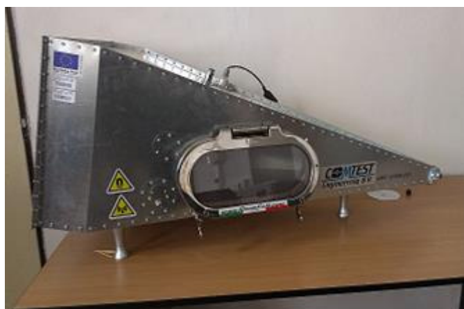
Obr. 2 Expozičná komora EMC GTEM 250
