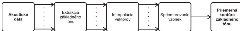
Obr. 2 Bloková schéma evaluačnej procedúry pre vyhodnocovanie základného tónu
