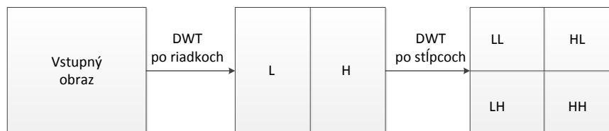
Obr. 1 Jedno – úrovňová 2D DWT dekompozícia obrazu
