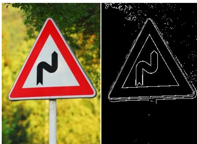
Obr. 2 Detekcia hrán v obraze s dopravnou značkou.
