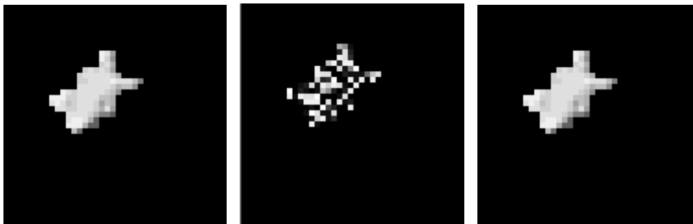
Obr.2 Vľavo detail reálneho segmentu, v strede detail segmentu po priamej transformácii vykonanej Householderovou ortogonalizáciou, vpravo detail segmentu po spätnej transformácii
