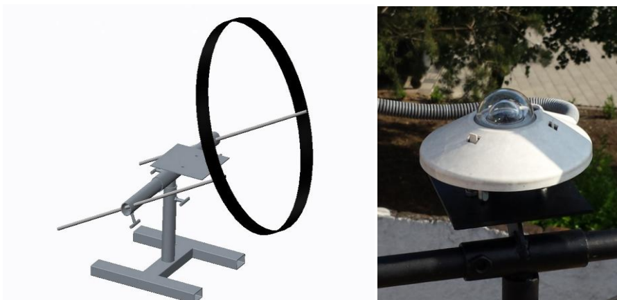
Obr. 2 Tienenie senzora pyranometra tieniacim kruhom
