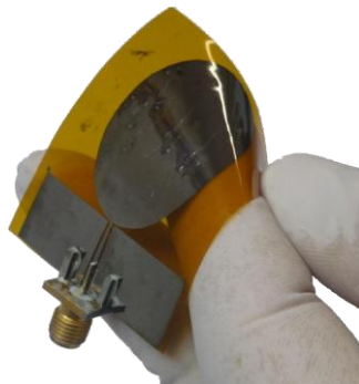
Obr. 1 UWB anténa vyrobená technológiou InkJet Printing na polyimidovom substráte Kapton ® HN.
