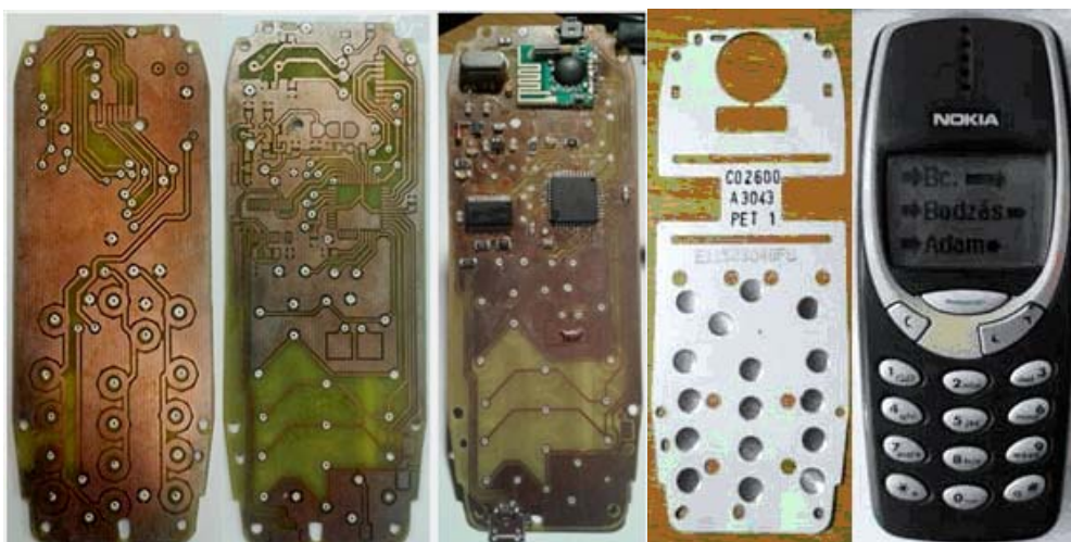
Obr. 5 Konfiguračný modul po prepojení vrstiev a osadení, klávesnicová fólia s kovovými mostíkmi a kompletný modul
