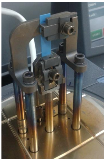
Obr. 3 Skúška ťahom v zariadení pre DMA analýzu.
