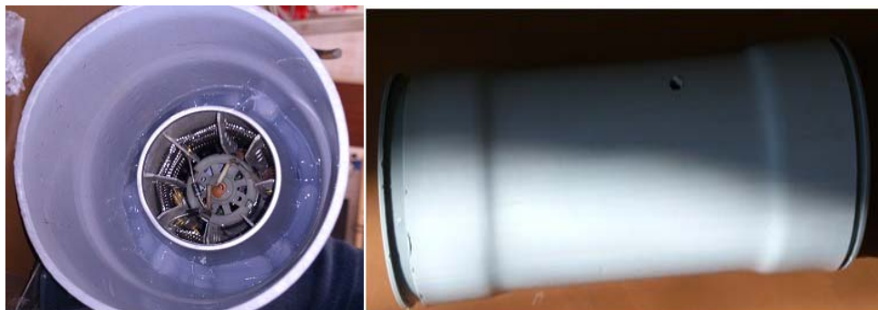
Obr. 3 Tubus s umiestneným odporovým telesom pre ohrev pracovnej kvapaliny
