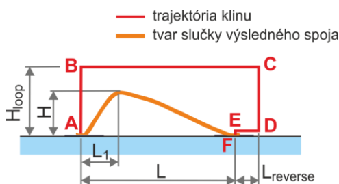
Obr. 4 Vytváranie slučky kontaktovaného spoja na zariadení Kulicke and Soffa 4129
