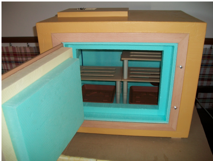
Obr. 1 Inkubátor ošetrový povrchovou úpravou s uzatváracími dvierkami
