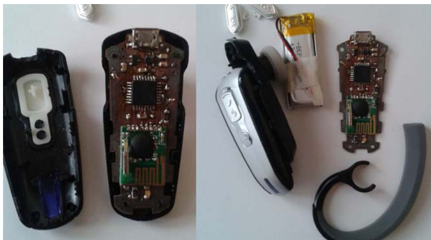
Obr. 3 Sluchový signalizátor a) v puzdre z Bluetooth handsfree, b) pred zapuzdrením
