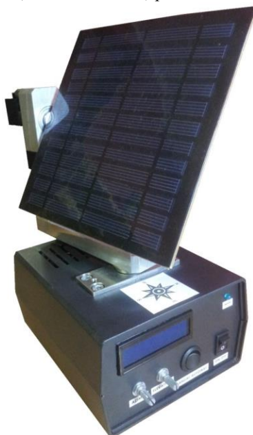
Obr. 2 Model vyrobeného solárneho trackera
