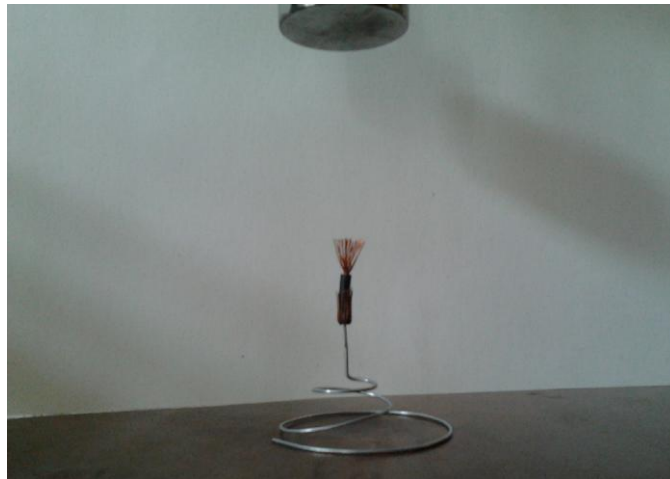
Obr. 5 Elektródový systém simulujúci usporiadanie zachytávacie zariadenie a mračno.
