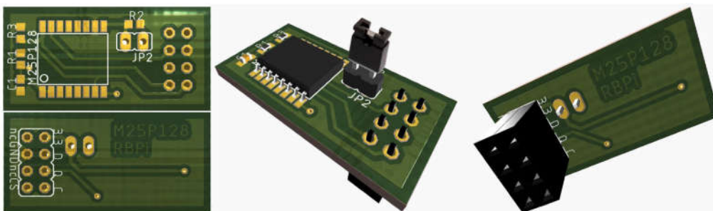
Obr. 3: 3D model návrhu DPS a 3D model modulu DPS s osadenými súčiastkami
