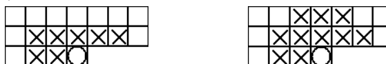
Obr.2 Ukážka rôznych typov šablón, vľavo je 7-bodová a vpravo je 10-bodová JBIG šablóna.
