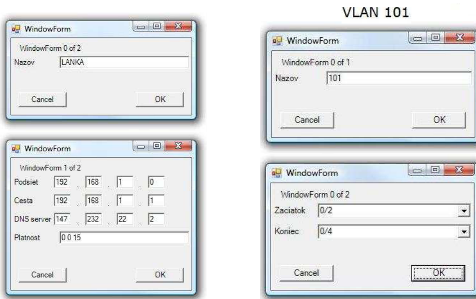
Fig. 4 Ukážka použitia makra pre konfiguráciu DHCP a rozsahu protokolov
