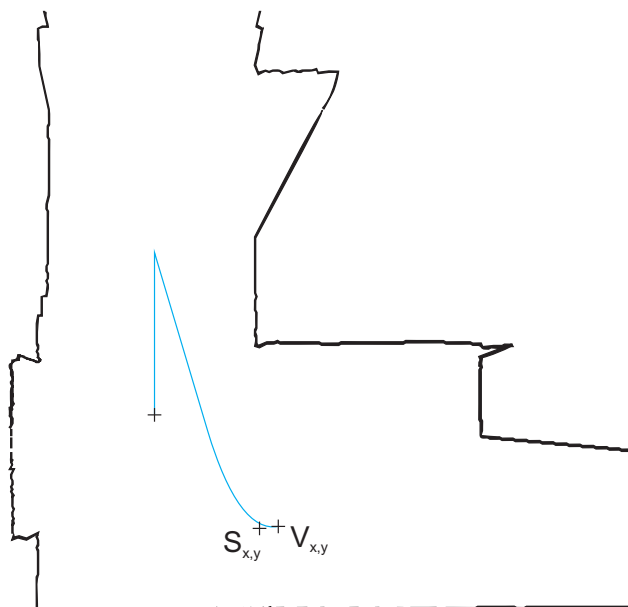
Obr. 4 Porovnanie vypočítanej polohy a skutočnej nameranej polohy vozidla
