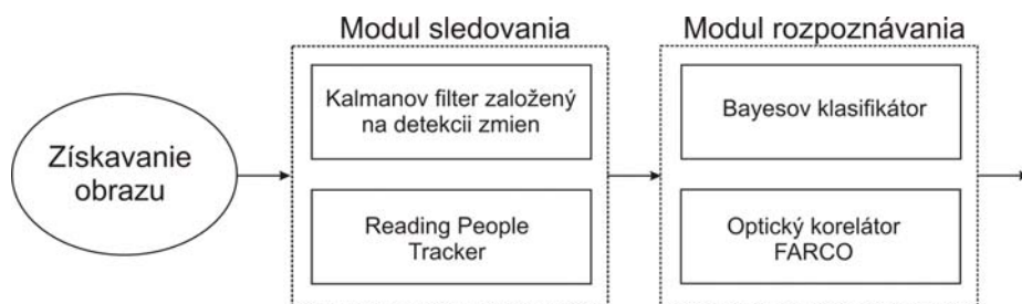
Obr. 1 Bloková schéma navrhnutého systému na detekciu opustenej batožiny
