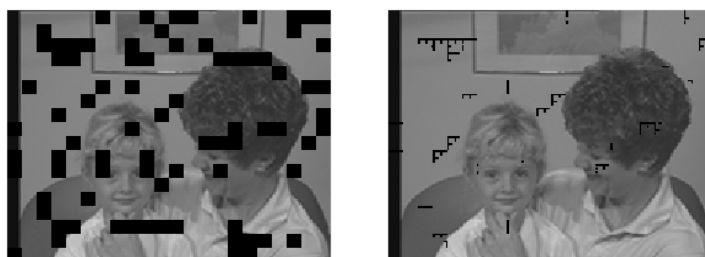
Obr. 4 Chybná a opravená snímka č. 174 videosekvencie Mother_Daughter . Počet chybných blokov je 80
