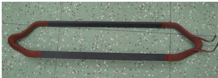
Obr. 2 Satorová cievka 6 kV
