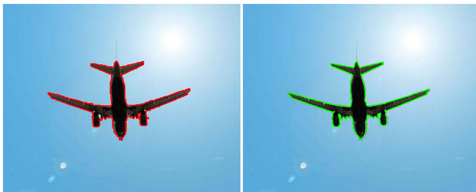
Obr. 3 a) Vľavo: Inicializačná kontúra získaná pomocou metódy Graph cut pre Aktívnu kontúru, b) Vpravo: Výsledná kombinovaná segmentácia po 100 iteráciách za čas t=5.2751s
