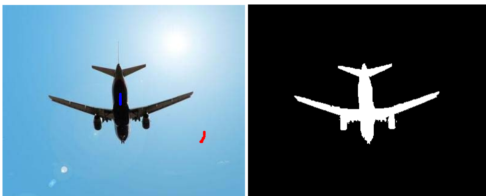
Obr. 2 a) Vľavo: Inicializácia pre Graph cut, b) vpravo: Samotná Graph cut segmentácia pre \sigma=0,5 t=0,32885
