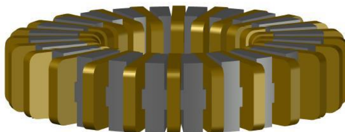
Obr. 10 Model diskového statora s axiálnym vinutím
