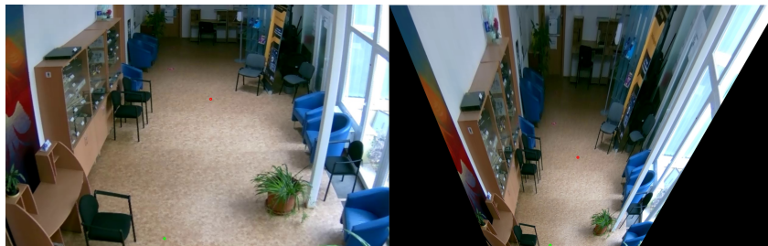
Obr. 1: Označené koncové body (zelený – štart, červený – cieľ) letu drona na kamerovom obraze a z vtáčej perspektívy
