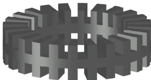
Obr. 9 Model drážkovaného disku statora
