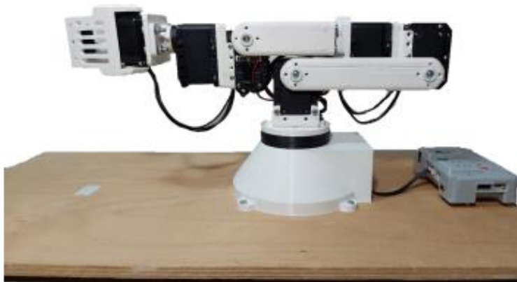
Obr. 6 Robotické rameno so šiestimi stupňami voľnosti
