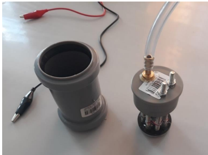
Obr. 2 Vytvorený elektrolyzátor pre generovanie paliva pre palivový článok
