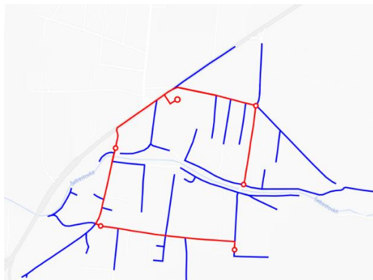
Obr. 4 FTTH sieť Prešov – Nižná Šebastová – trasa primárnej a sekundárnej časti siete.
