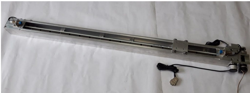
Obr. 6 Mechanická časť lineárneho pohonu so zabudovaným jednosmerným motorom a inkrementálnym snímačom
