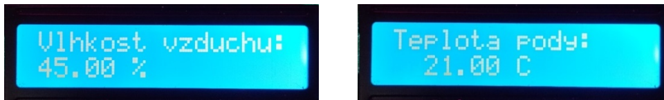
Obr. 12 Zobrazenie načítanej hodnoty zo senzora vlhkosti vzduchu a zo senzora teploty pôdy.
